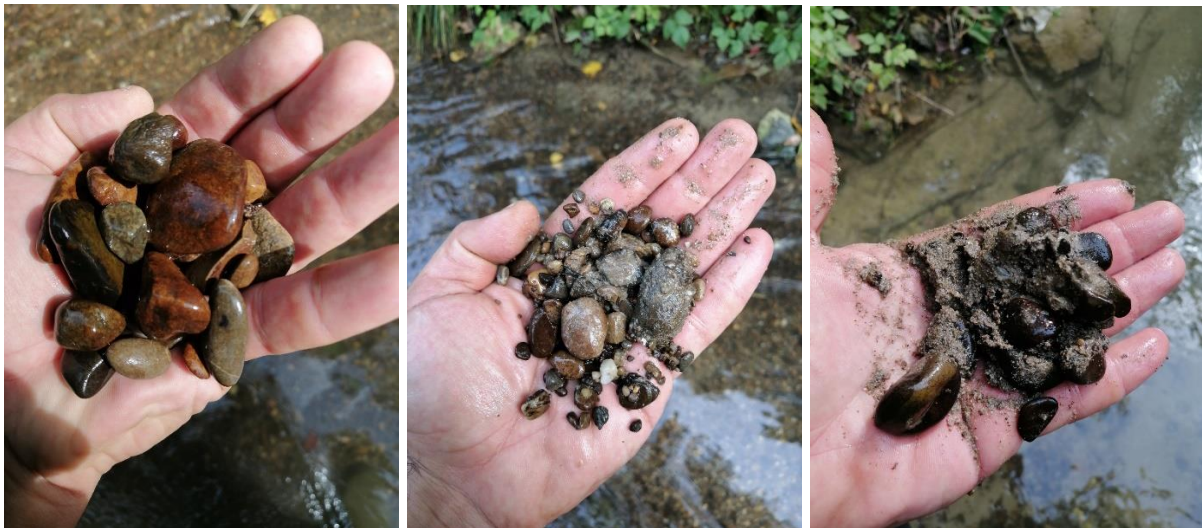
Abb. 20: Handproben zur Feststellung des Kolmationsgrades: (linke Probe: keine Kolmation ; Mitte: fortgeschrittene Kolmation ; rechts: vollständige Kolmation)
